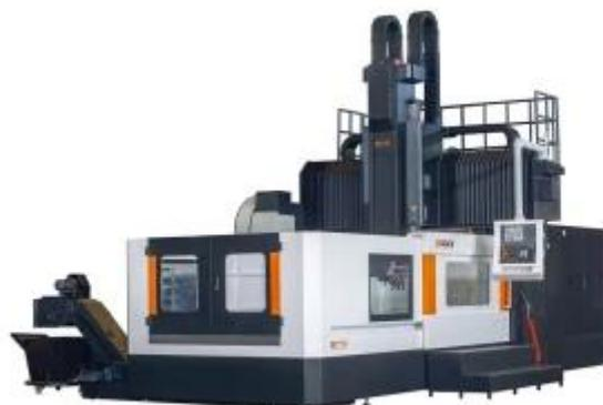
**SP1325** - Двухколонный обрабатывающий центр с высокой степенью жесткости для тяжелой резки.
